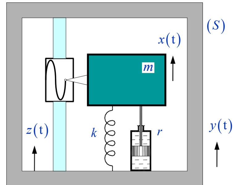
La massa può muoversi solo in una prefissata direzione, quella del moto vibratorio che s'intende misurare, in modo da riprodurre lo schema di figura.
