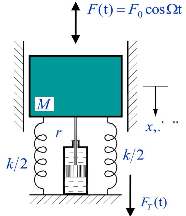
Allo scopo consideriamo lo schema riportato in figura, in cui è schematizzato un sistema vibrante forzato da una generica forzante armonica del tipo:
